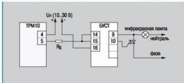
БУСТ может преобразовывать аналоговый сигнал в ФИМ-сигнал, что позволяет использовать его совместно с приборами ОВЕН, имеющими на выходе ЦАП «параметр-ток 4...20 мА». Например, для управления яркостью свечения инфракрасной лампы при сушке краски.
