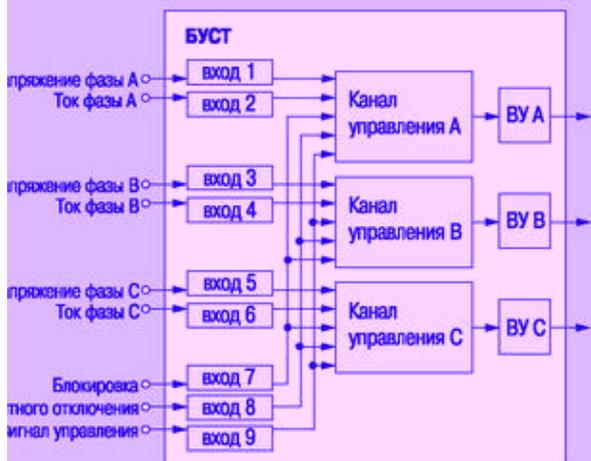
**Три канала для управления одно-, двух- или трехфазной нагрузкой**
